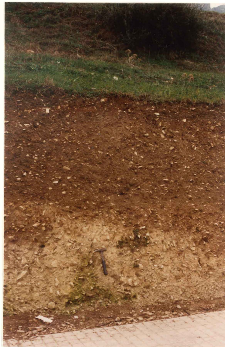
FOTOGRAFIA 6: Aspecto que presenta el Coluvial sobre el que se producen los deslizamientos.
